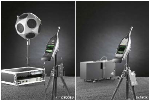
建筑声学套装范例 (左：2270+无指向性声源+功放，右：2250+地板打击器)
