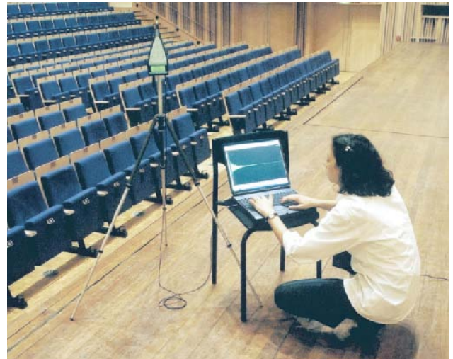
7841型DIRAC建筑声学测量软件， 可以作为2250/2270型手持式分析仪的补充，也可独立工作。
