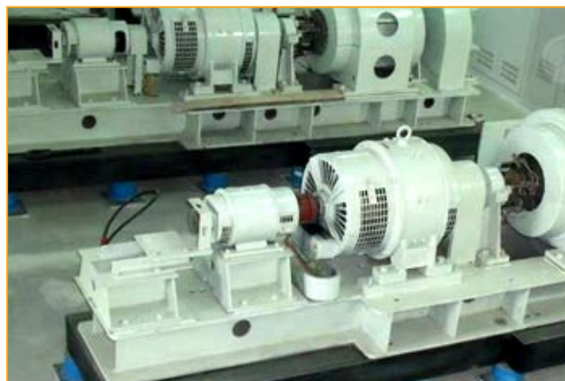
ZTG弹簧隔振器用于励磁发电机隔振
